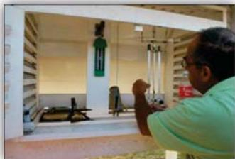
✎ Para humedad; hidrógrafo.
