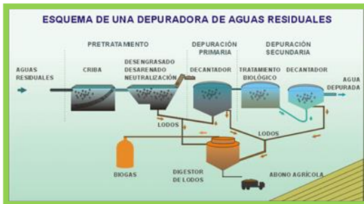
Figura 2. Se observan el pre-tratamiento, depuración primaria (tratamiento biológico) y depuración terciaria. 4
