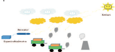
Figura 7. DOAS pasivo principales componentes, el sol es la fuente de luz y la parte inferior izquierda se ve el receptor y el espectrofotómetro.
