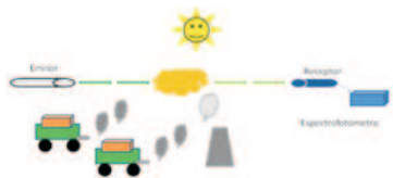
Figura 6. Principales componentes del DOAS activo.
