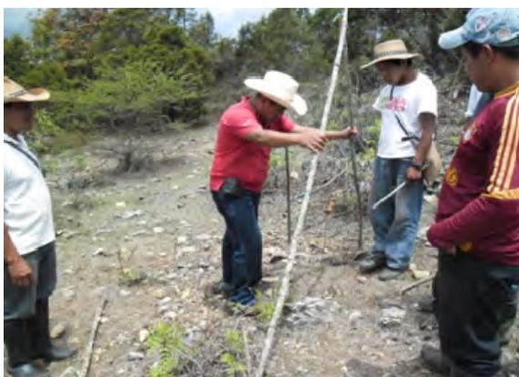
Figura 1. Terminado de construir el aparato "A" se calibra con la plomada para obtener la pendiente del terreno.
