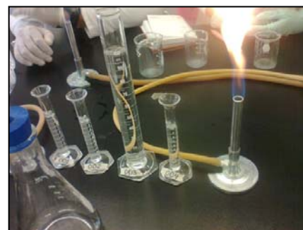
Fig. 12 Preparación de diluciones de la muestra de agua residual.
