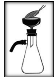
Figura 3. Colocar la membrana sobre el soporte de la base del filtro con la cuadrícula hacia arriba. Fuente: UAM, 2012.
