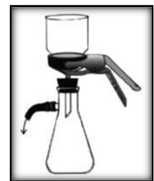
Figura 4. Ensamblar el embudo. Fuente: UAM, 2012.
