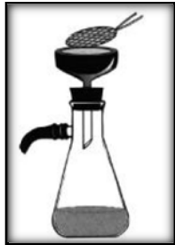
Figura 6. Desamblar el embudo y retirar la membrana con pinzas estériles. UAM, 2012.
