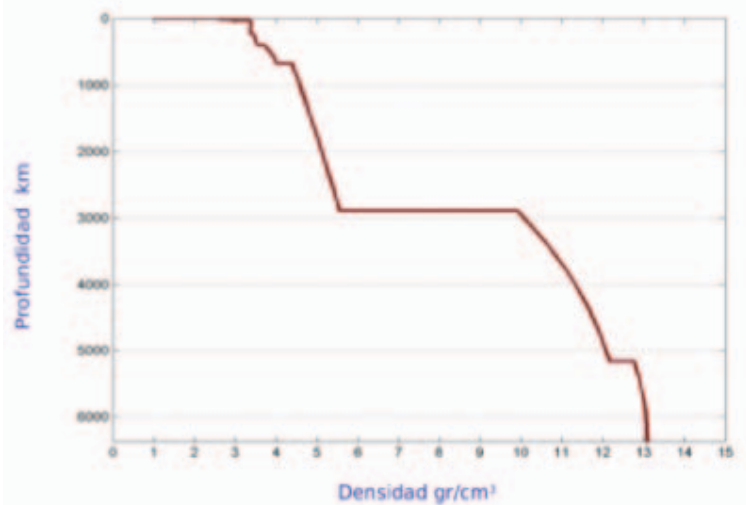
Figura 3. Comportamiento de la densidad en función de la profundidad, datos tomados del PREM.
