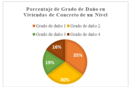
Gráfico III. Porcentaje de grado de daño en viviendas de concreto de un nivel.
