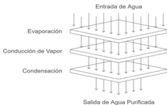
Figura 2. Proceso de purificación del agua. Autoría propia.
