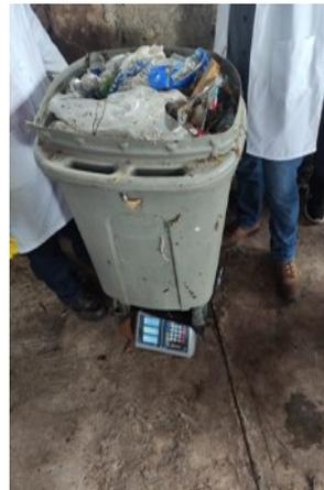
**Imagen 3.** Determinación del peso volumétrico
